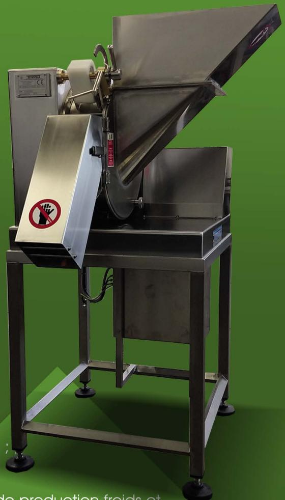
La transmission des différents mouvements est obtenue par un moteur électrique et une courroie crantée.
