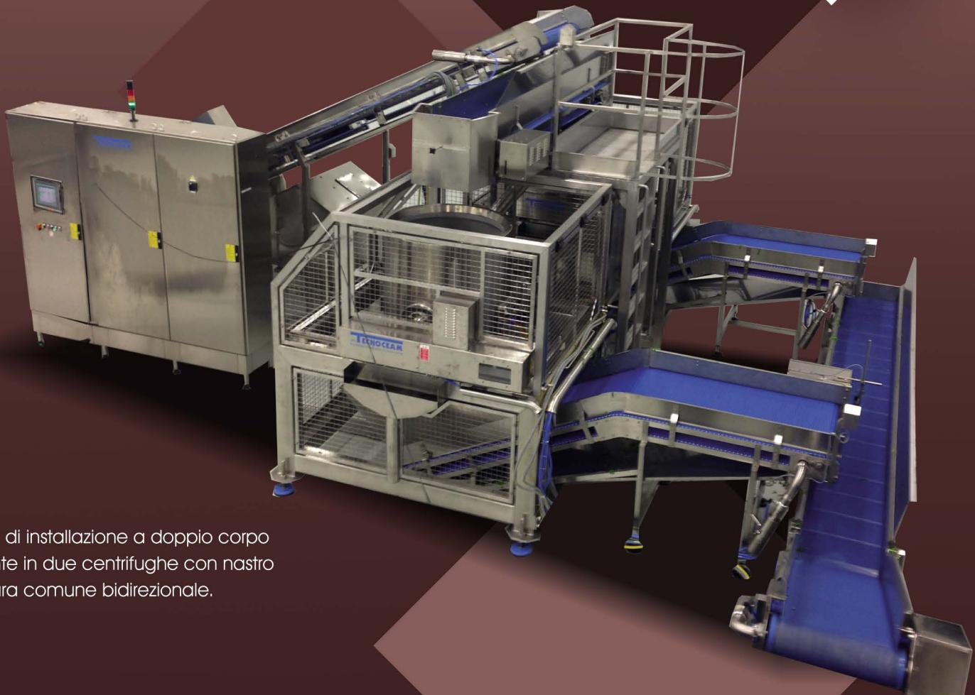
Possibilità di installazione a doppio corpo consistente in due centrifughe con nastro di pesatura comune bidirezionale.
