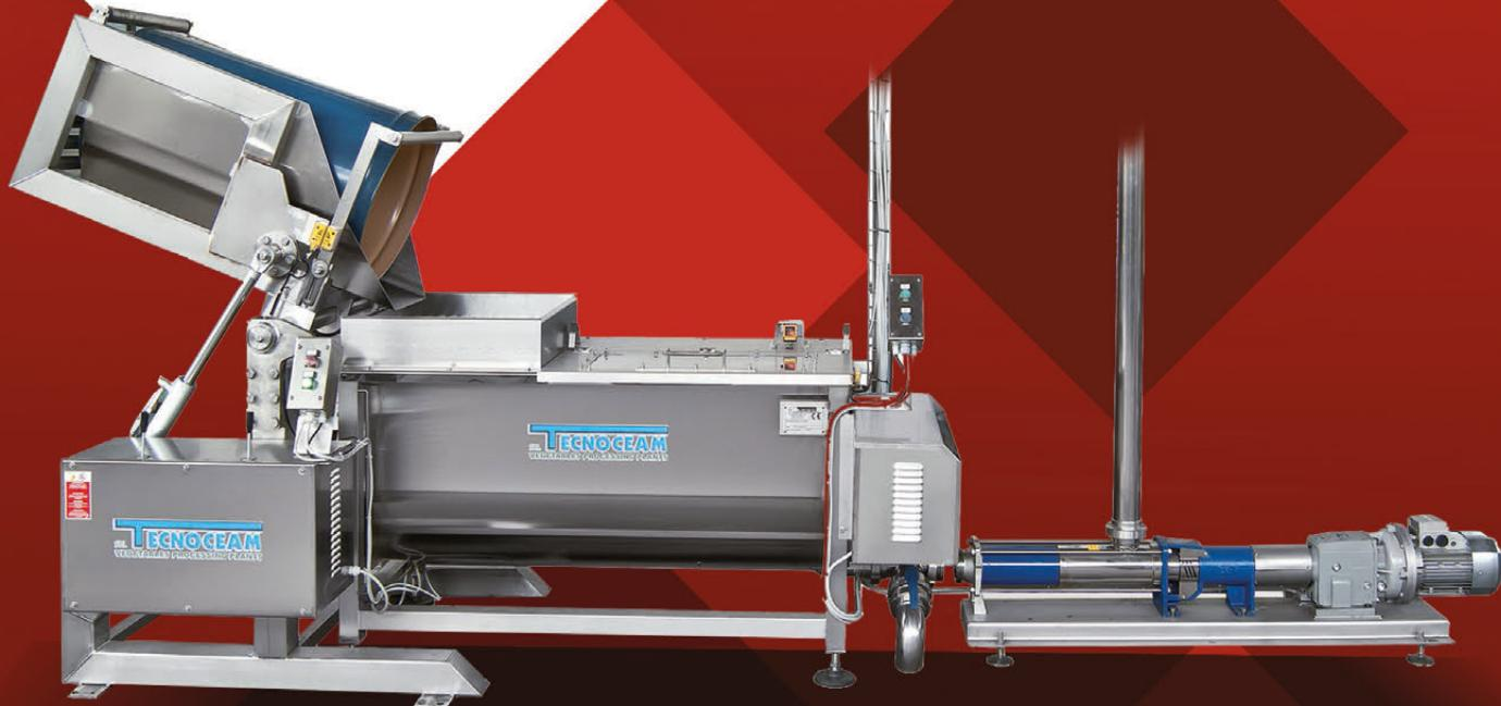
Sistema con Ribaltafusti, Miscelatore e pompa volumetrica di estrazione integrato in linea pesto di basilico
